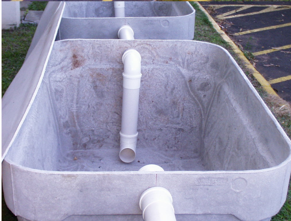
Figura 2 – Foto de um biodigestor montado. a) vista lateral e b) vista superior.
